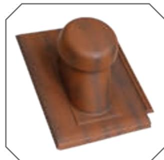
**Set za ventilaciju bez gibljivoog creva:** Element koji služi za provetrvanje ventilacija izvodnih cevi, koji se može koristiti kod nagiba krova 20–55°. Kapa koja pokriva cev sprečava ulazak padavina, dok rešetka na kraju cevi sprečava ulazak ptica i insekata. Materijal je tvrdi PVC.
