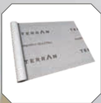
**MediFol Wind Plus:** Paropropusna folija sa integrisanim trakom za lepljenje. Krovna folija je troslojna, sastoji se od dva sloja polipropilenske tkanine i funkcionalnog polipropilenskog filma. Koji osigurava visoku vodonepropusnost i paropropusnost. Otpornost na UV zračenja u trajanju od 4 meseca, osigurana je specijalnim stabilizacijskim aditivima, a omogućuje odlaganje pokrivanja krova. Osigurava visok kvalitet, funkcionalnost i dugotrajnost proizvoda.
