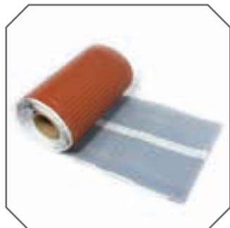
**3D Flex (ivica dimnjaka i zida):** Fleksibilan element koji služi za zatvaranje priključaka dimnjaka i krova. Osnovni materijal je aluminijum, sa slojem lepka na zadnjoj strani, koji ni na uticaj toplove ne gubi sposobnost prijanjanja. Može se lako oblikovati rukom, prijanja uz površinu crepova. Osigurava trajnu zaštitu od prodora kiše i snega. Isključivo se može lepiti na suvu površinu na kojoj nema prašine, masti i ulja.
