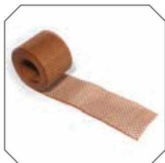
**Traka za zaštitu i provjetranje strehe:** Obično se ugrađuje po ivici strehe i omogućava ventilaciju ispod krova. Traka propušta vazduh unutra, ali veći insekti i ptice ne mogu ući pod krov. Kod talasastog crepa koristi se zajedno sa češljjem za zatvaranje. Traka je napravljena od elastične plastike i učvršćivanje se može izvršiti ekserima, na svakih cca. 20 cm-a radi boljeg prijanjanja.
