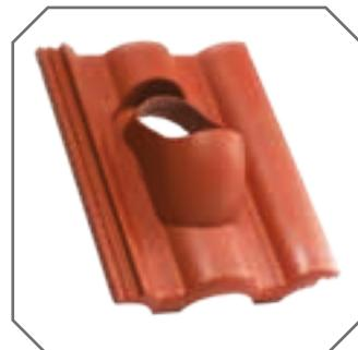
**Plastični osnovni crep:** Pogodan je za montažu izlazne cevi za antenu, odnosno ventilacije. Učvršćivanje se vrši za letvu crepa koristeći žicu. Materijal je tvrdi PVC.
