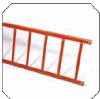
**Rešetka za zadržavanje snega i nosač rešetke za zadržavanje snega:** Služi za sprečavanje proklizavanja veće količine snega, u slučaju strmog krova, odnosno velikih visina zgrada. Treba postaviti blizu nadstrešnice, efikasno zadržavanje snega ostvaruje samo uz ugradnju u celoj dužini nadstrešnice. Učvršćivanje se može izvršiti za dasku/krovnu letvu postavljenu posebno s tim ciljem, na 3 tačke, pomoću šrafova. Element za držanje rešetke mora leći u udubljenje talasastog crepa.
