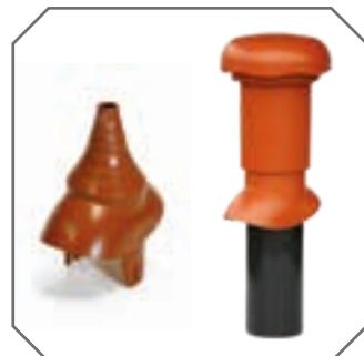
**Adapter izlaz za antenu:** Koristiti za montažu izlazne cevi za antenu koji prijana uz plastični osnovni crep, kod nagiba krova od 20–55°. Kod montaže se izreže vrh adaptera zavisno od širine cevi. Prazninu treba ispuniti elastičnim materijalom za zaptivanje kako padavine ne bi prodrle ispod plastičnog crepa. Materijal je tvrdi PVC.
