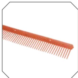
**Češalj za zatvaranje:** Treba ugraditi po ivici strehe. Vrhovi češlja prate liniju donje površine crepa i puštaju unutra vazduh za ventilaciju ali veći insekti i ptice ne mogu ući pod krov. Češalj je napravljen od elastične plastike i njegovo učvršćivanje se može izvršiti sa ekserima ili pomoću šrafova svakih cca. 20 cm. Može se primeniti i kod uvala.
