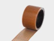
Obično se ugrađuje po ivici strehe i omogućava ventilaciju ispod krova. Traka propušta vazduh unutra, ali veći insekti i ptice ne mogu ući pod krov. Kod talasastog crepa koristi se zajedno sa češljom za zatvaranje. Traka je napravljena od elastične plastike i učvršćivanje se može izvršiti ekserima, na svakih cca. 20 cm-a radi boljeg prijanjanja.
