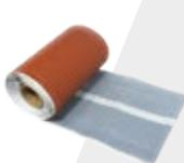
Fleksibilan element koji služi za zatvaranje priključaka dimnjaka i krova. Osnovni materijal je aluminijum, sa slojem lepka na zadnjoj strani, koji ni na uticaj topote ne gubi sposobnost prijanjanja. Može se lako oblikovati rukom, prijanja uz površinu crepova. Osigurava trajnu zaštitu od prodora kiše i snega. Isključivo se može lepiti na suvu površinu na kojoj nema prašine, masti i ulja.
